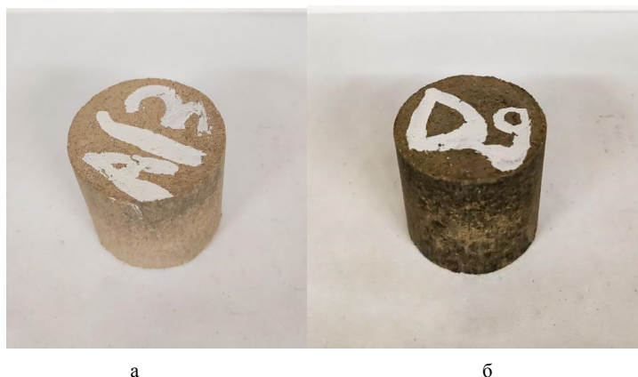
Рис. 1. Шламогрунтовые образцы укрепленные щелочью: а – гидроксид калия, б – гидроксид натрия
