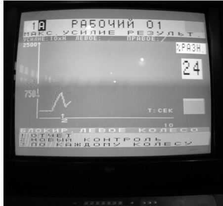
Рис. 1. Графическое изображение тормозных сил правого и левого (экспериментального, красный график) колес автомобиля
