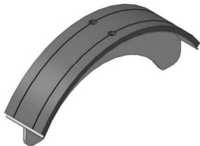
Рис. 3. Колодка с прямолинейными продольными геометрическими рисунками на накладке
