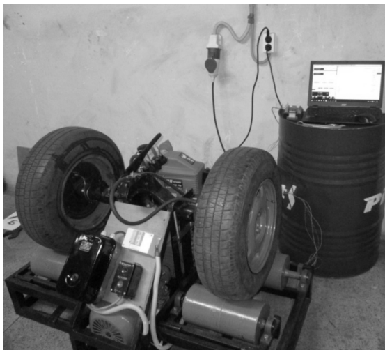
Рис. 2. Принципиальная схема экспериментальной установки тормозного стенда
