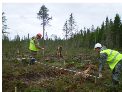
Рис. 2. Замеры колеи на пробном участке с 4 проходами техники
