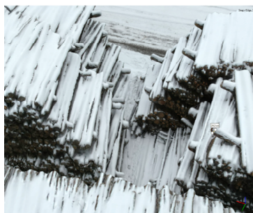
Рис. 6. Разрывы и пустоты в штабелях круглых лесоматериалов
