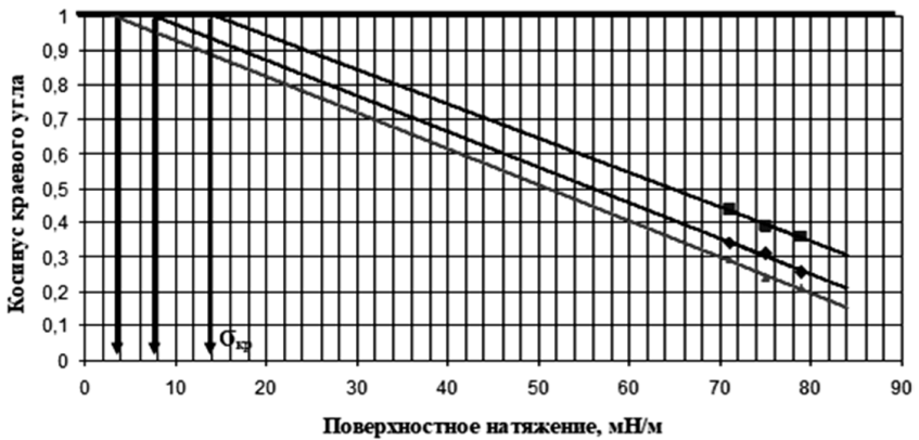
Рис. 1. Зависимость косинусов краевых углов от поверхностного натяжения клеевой композиции на основе МКФС и аэросила технического
