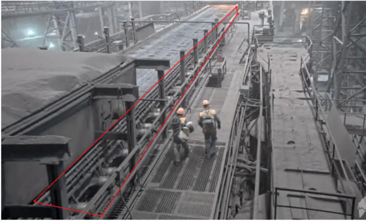
Рис.3. Пример контроля опасных зон Fig.3. Example of hazardous area monitoring
