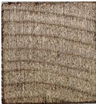
*Рис. 3. Поперечный срез образца окрашенной древесины березы*
