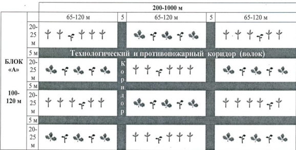
Рис. 3. Территориально-схематическая организационно-технологическая структура «пасечно-полосно-шахматного» способа лесовосстановительных и последующих мероприятий
