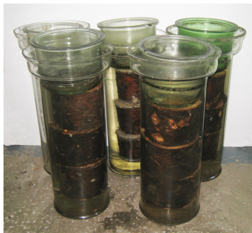
Рис. 1. Внешний вид эксперимента по затоплению отрубков бревен пихты
