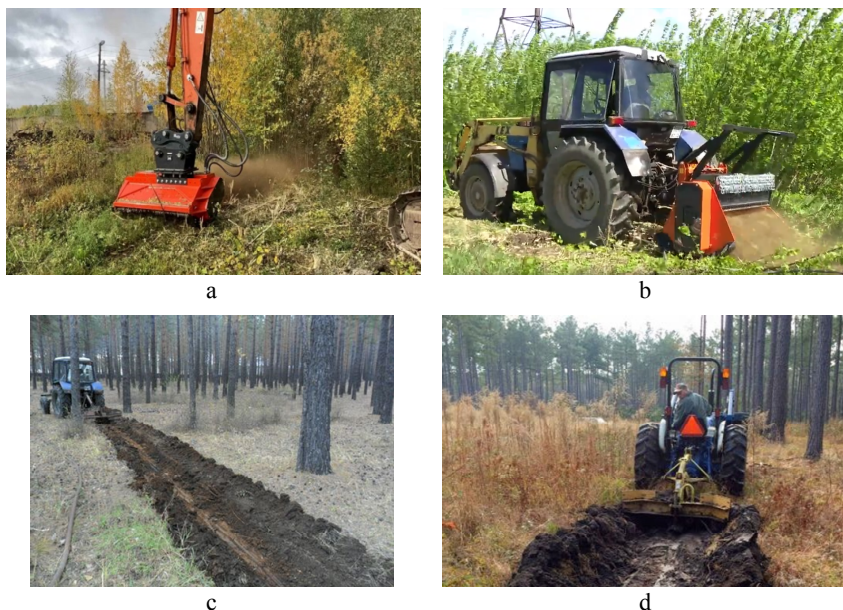
Рис. 4. Механизированные устройства для обустройства минерализованных полос: а) мульчер Impulse; б) мульчер Forster; в) плуг ПКЛ-70; д) ПЛК-2.0
