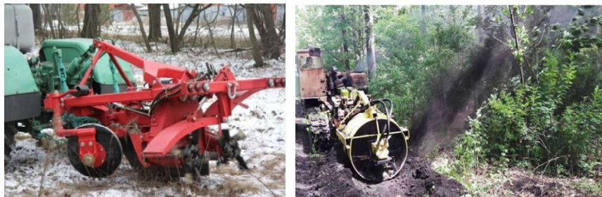
Рис. 5. Лесопожарный грунтomet-полосопрокладыватель с улучшенными техническими и эксплуатационными характеристиками
