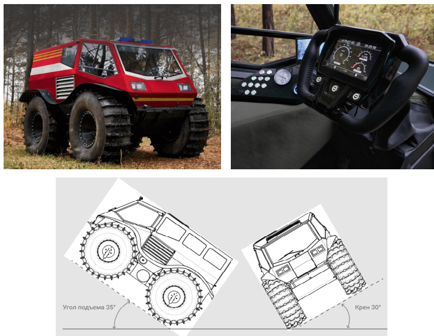
Рис. 8. Колесный вездеход АГ-30 с бескамерными шинами низкого давления, предназначен для субъектов лесного хозяйства и лесной промышленности
