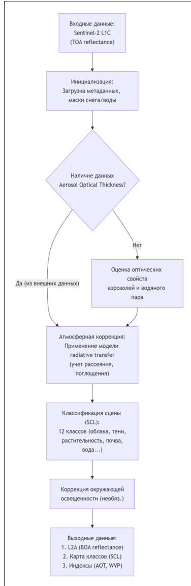
Рис. 1. Схема работы алгоритма Sen2Cor Fig. 1. Operation scheme of the Sen2Cor algorithm
