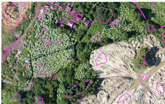
Рис. 5. Пример формирования обучающей выборки для изображения тестового участка на территории д. Ручьи Ленинградской области. Фиолетовыми контурами на изображении показаны границы отдельных классов объектов
