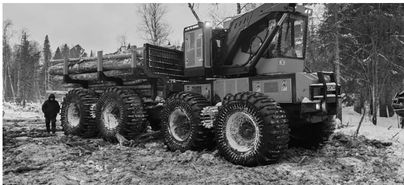
Рис. 3. КС ТРОМ, модель 25 Fig. 3. Wheeled forwarder TROM, model 25
