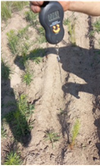
Рис. 2. Измерение усилия выдергивания сеянца из почвы
