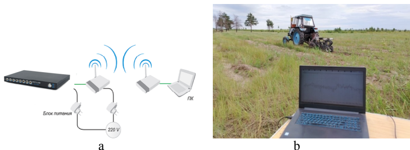
Рис. 4. Общий вид тензометрического оборудования: а – тензометрическое оборудование; б – тензометрическое оборудование с тензонавеской в работе
