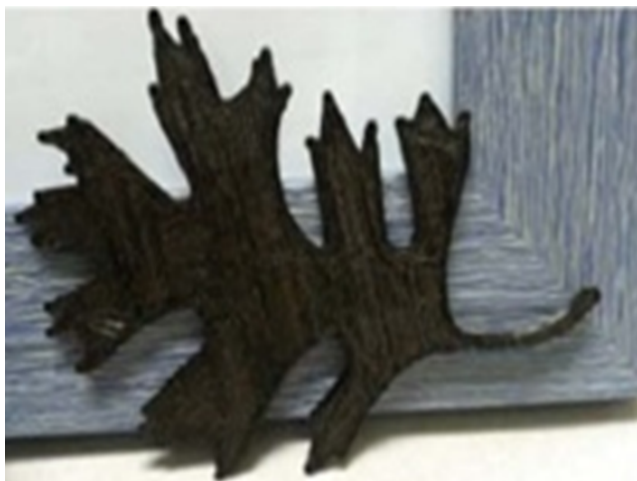
Рис. 14. Изделие, полученное методом 3D-печати из композиции, содержащей 40% органосолвентного лиственного лигнина, в форме дубового листа [Nguyen et al., 2018]
