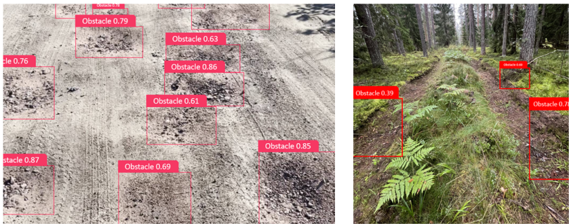
Рис. 6. Пример распознавания препятствий в виде ям (YOLOv8m.pt)
