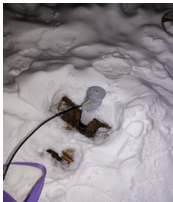
Рис. 8. Подключение кабеля к температурной трубке
