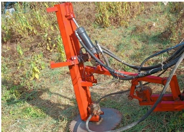
*Рис. 1. Экспериментальный образец захватно-срезающего устройства с механизмом вибрации*
