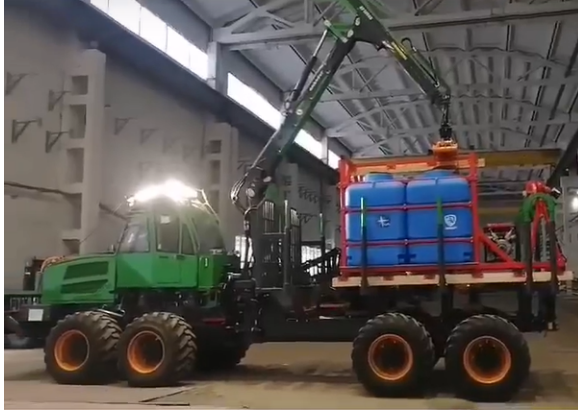
Рис. 6. Усовершенствованный мобильный комплекс для тушения лесных пожаров (разработка ведущих и молодых ученых ПетрГУ)
