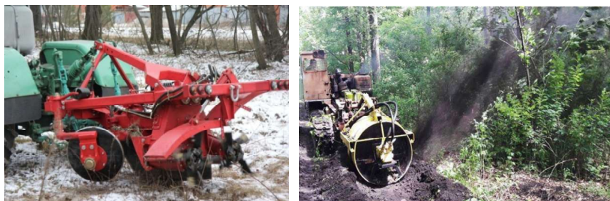
Рис. 5. Лесопожарный грунтомет-полосопрокладыватель с улучшенными техническими и эксплуатационными характеристиками
