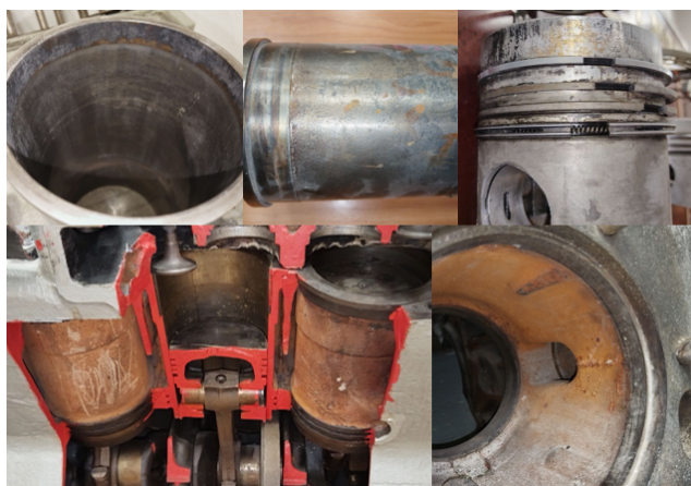
Рис. 2. Примеры деталей цилиндро-поршневой группы, подверженных коррозионному износу
